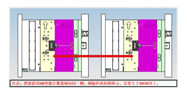
EMITTIMS模具智能计数器是广东新睿任德智能系统有限公司开发的模具智能化数据采集器,属于无源设备互联智能化数据采集器。产品自带无线定位模块、计数模块和数据传输模块。主要功能是自动为模具提供位置信息、数量信息和成型周期等信息,利用以上信息通过软件系统大量逻辑运算为模具全流程监控和运营提供智能化管理。运营管理平台主要解决大量模具在注塑和冲压生产过程中运营管理难的痛点问题,应用场景:主机企业(美的、华为等)有大量模具外发多家供应商生产[MITT模具生产运营智能管理系统化解决方案,通过模具智能RFID数据采集器[]4G[]5G智能采集器配合智能化管理系统对模具进行全生命周期管理,解决企业大量模具外协供应商生产难以运营管理的痛点问题。计数架构:每套模具安装智能数据采集器一个(内置定位、计数、通讯模块)自动采集数据;系统通过4G[]5G通讯基站定位及传输数据,云端服务器数据运算;云端服务器运行智能化管理系统,通过系统完成数据智能化运算,展示在企业PC端、移动端和电子看板;通过模具智能数据采集器实时采集数据,云端计算,通过PC端、移动端和电子看板呈现数据报表、异常实时提醒等智能化管理。9
