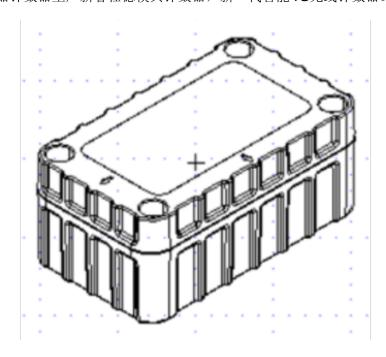
EMITTIMS模具智能计数器是广东新睿仕德智能系统有限公司开发的模具智能化数据采集器,属于无源设备互联智能化数据采集器。产品自带无线定位模块、计数模块和数据传输模块。主要功能是自动为模具提供位置信息、数量信息和成型周期等信息,利用以上信息通过软件系统大量逻辑运算为模具全流程监控和运营提供智能化管理。运营管理平台主要解决大量模具在注塑和冲压生产过程中运营管理难的痛点问题,应用场景:主机企业(美的、华为等)有大量模具外发多家供应商生产[MITT模具生产运营智能管理系统化解决方案,通过模具智能RFID数据采集器 4G 5G 智能采集器配合智能化管理系统对模具进行全生命周期管理,解决企业大量模具外协供应商生产难以运营管理的痛点问题。计数架构:每套模具安装智能数据采集器一个(内置定位、计数、通讯模块)自动采集数据;系统通过4G 5G 通讯基站定位及传输数据,云端服务器数据运算;云端服务器运行智能化管理系统,通过系统完成数据智能化运算,展示在企业PC端、移动端和电子看板;通过模具智能数据采集器实时采集数据,云端计算,通过PC端、移动端和电子看板呈现数据报表、异常实时提醒等智能化管理。110
